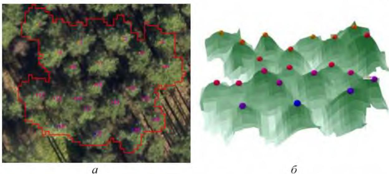
Рис. 3.11. Приклад визначених локальних максимумів, використовуючи ЦММ: *а* – вигляд на аерофотознімку; *б* – візуалізація 2,5D.
