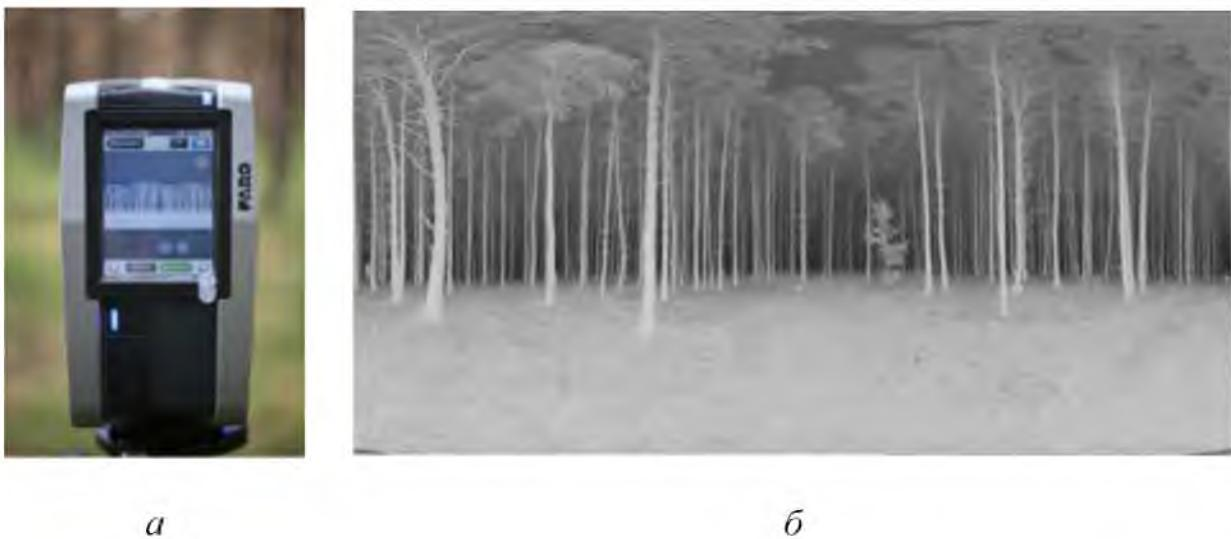
Рис. 3.5. Лазерне наземне сканування: *а* – сканер фірми FARO; *б* – приклад даних наземного лазерного сканування.
